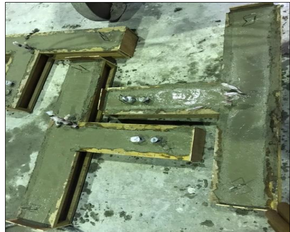
(d) Casting and Curing process of R-ECC
